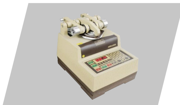
Test der Nutzungsstufen mittels Taber Abraser
