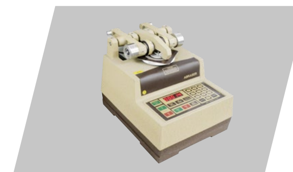
Taber Abraser abrasion test
